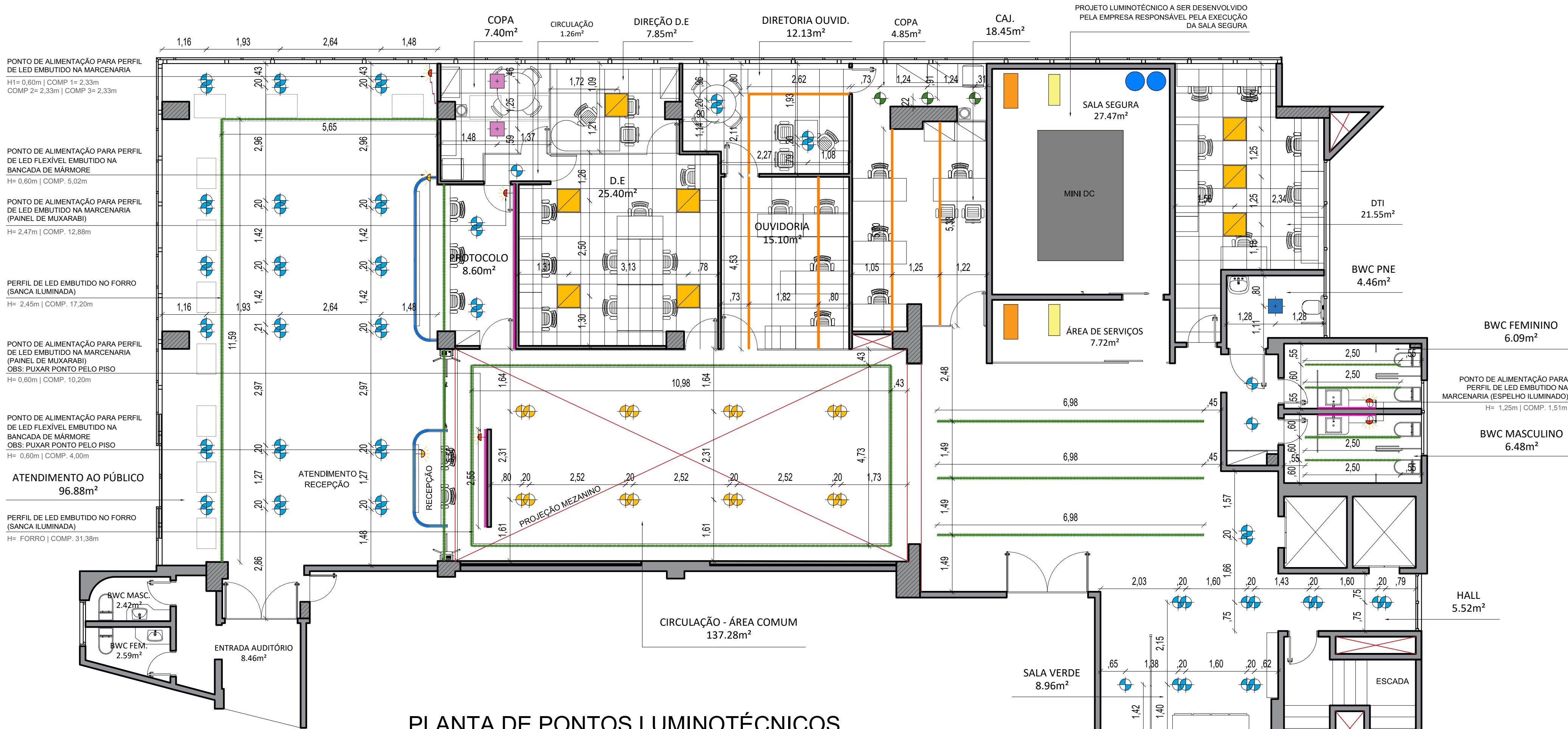
PLANTA DE PONTOS LUMINOTÉCNICOS ESCALA..... 1/75
